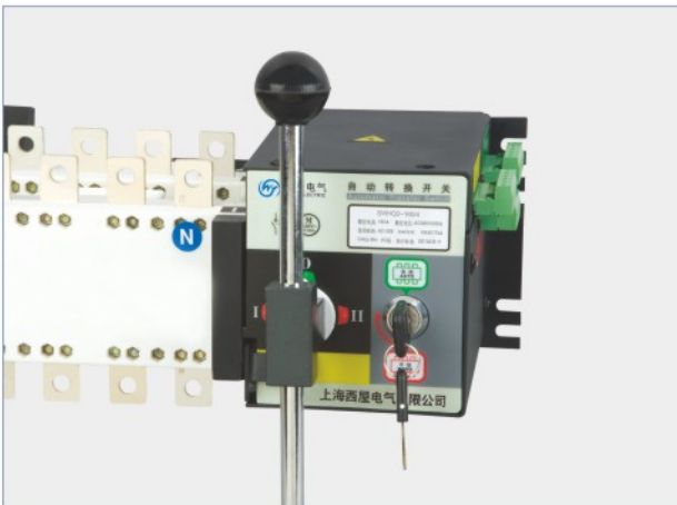
紧急手动操作：用紧急操作手柄，每一位置90° 转角。
